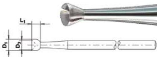
**Les fraises creuses (ou concave)**, la longueur de la partie travaillante L1, le diamètre extérieur de la partie travaillante D1 et le diamètre intérieur de la partie travaillante D3 sont précisés dans les attributs de chaque référence. Retrouvez les séries BUSCH N° 411T, 411 & 411 CT : pages 22 à 25.
