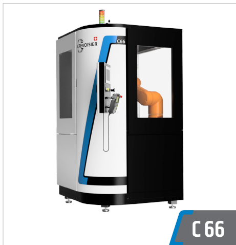
Cellule de chargement compact équipée d'un robot poly-articulé compatible avec un large panel de machines de toutes marques
