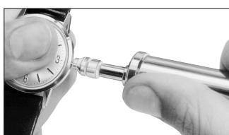
Mise en place de l'embout de la pompe sur le canon de la boîte.
