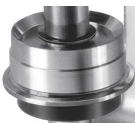
Pose d'un verre avec bague de tension sur une montre emboîtée.
