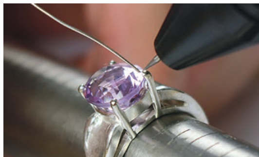
Réparation d'une griffe
