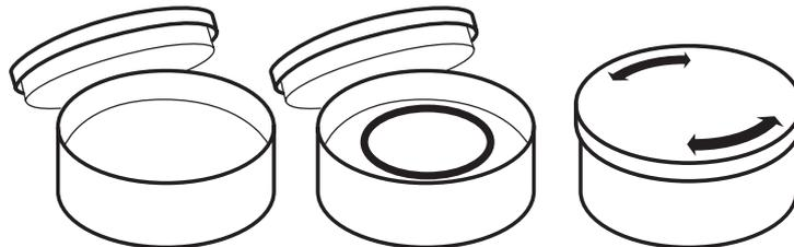
Afin de bien graisser le joint, il suffit de le déposer dans la boîte, refermer le couvercle et de le tourner d'un demi-tour dans les deux sens.
