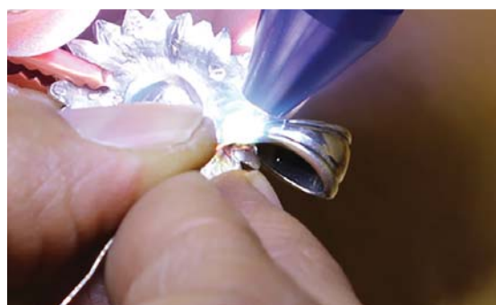
Soudure à proximité d'une pierre
