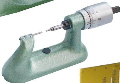
Pied en fonte vernie. Tambour chromé mat. Avance sans tourner. Divisions 0.01 mm. Capacité : 0 - 25 mm. Micromètre courbé, touches cylindriques en métal dur Ø 2 mm
