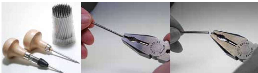
Réduire la longueur du perloir pour une utilisation sur pièce à main motorisée
